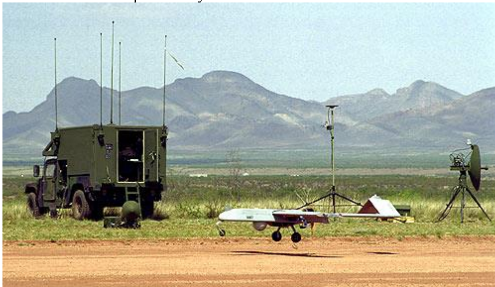
4.3 „Shadow 200 RQ-7“ UAV ir jo valdymo sistema
